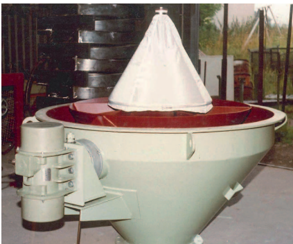
Austrags-Schwingtrichter DN 1650, Typ 9.22-004, August 1980
